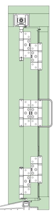
THIS BI-FOLD DOOR SET HAS BEEN TESTED TO FULL **PAS 24 : 2016** WHICH IS THE MOST UP TO DATE SECURITY TESTING IN THE UK. THE 2012 TEST IS NOW OBSOLETE AS COMPANIES HAD 2 YEARS GRACE TO COMPLY WITH THE LATEST 2016 TEST.
